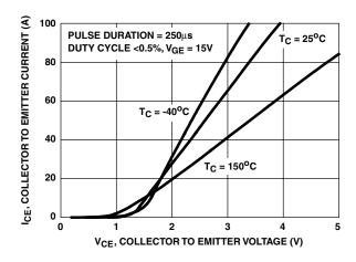
FIGURE 4. COLLECTOR TO EMITTER ON-STATE VOLTAGE
