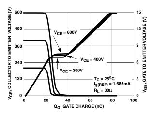
FIGURE 6. GATE CHARGE WAVEFORMS
