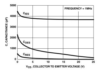
FIGURE 5. CAPACITANCE vs COLLECTOR TO EMITTER VOLTAGE
